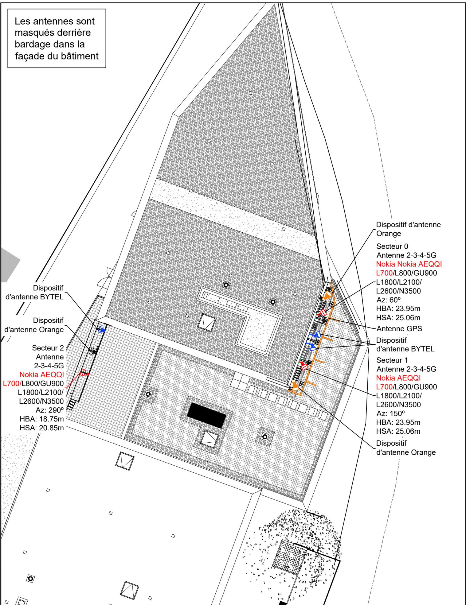
Dispositif d'antenne BYTEL
