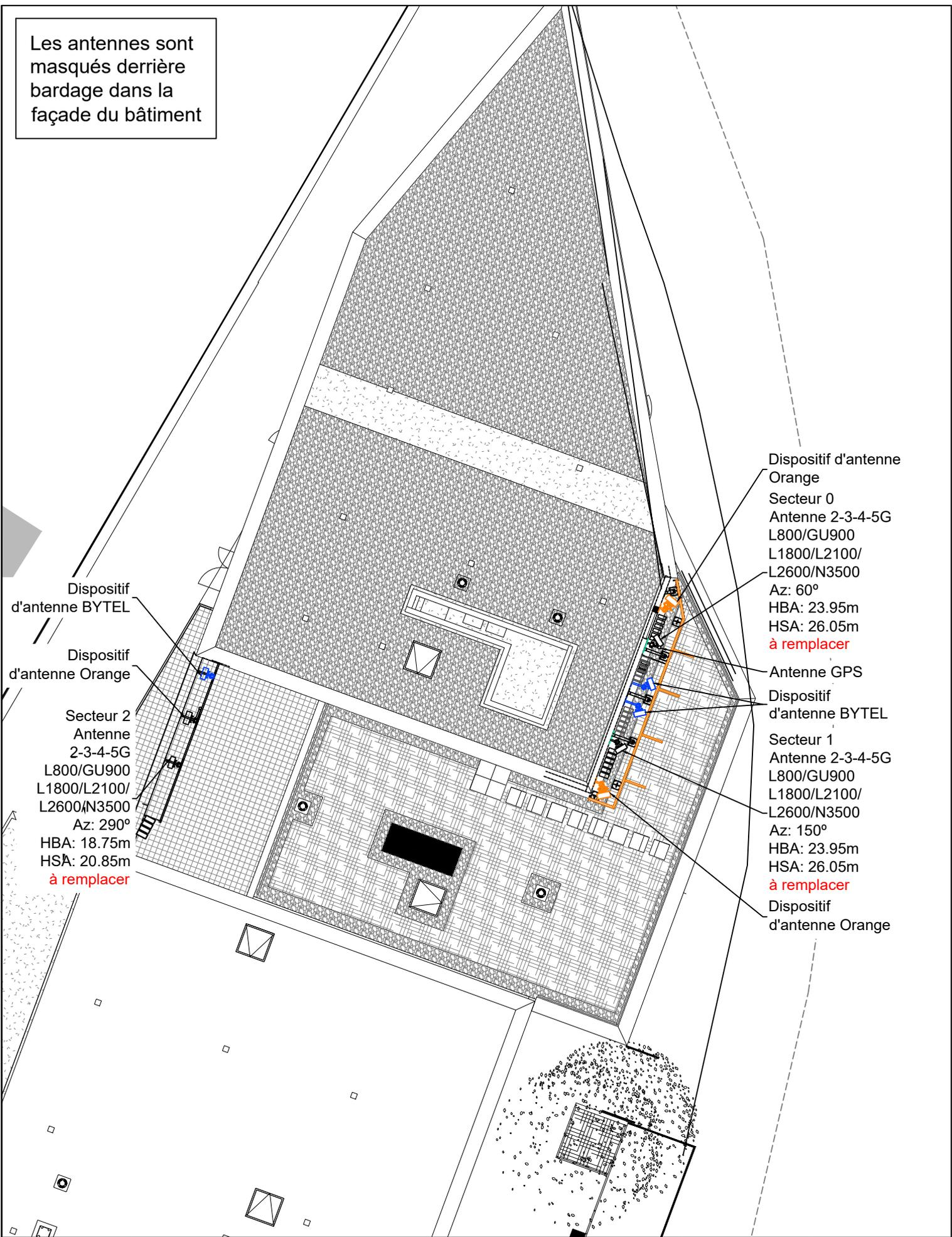
Dispositif d'antenne BYTEL
